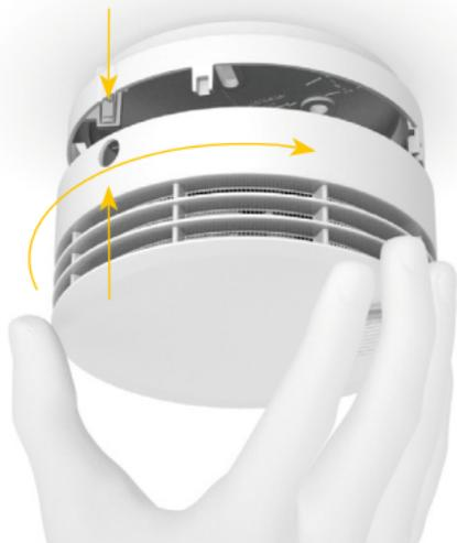
3. Sobald der Rauchwarnmelder in den Sockel gedreht ist, signalisiert er seine Betriebsbereitschaft durch einen einmaligen Dreifach-Ton und alle 48 Sekunden durch ein rotes LED-Signal. Zwischen 22:00 Uhr und 06:00 Uhr ist die LED gedimmt.
